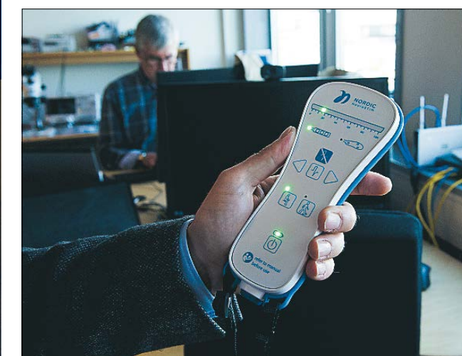
Betjeningsenheden til Incedo er forbundet med sensoren under patientens fod med et kabel.
